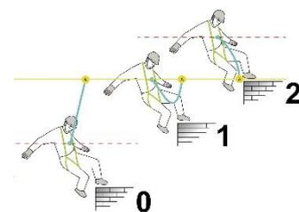
**Pour l'installation sur toiture, la ligne de vie doit être installée à au moins 2m du risque de chute**
