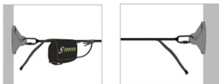
Fall 1: Es gibt Anschlagpunkte (EN 795 Typ A)
