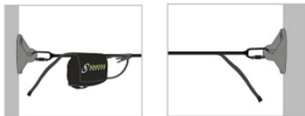
Eksempel 1: Der findes ankerpunkter (EN 795 Type A)
