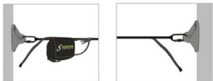
Tapaus 1: Kiinnityspisteitä on (EN 795 tyyppi A)
